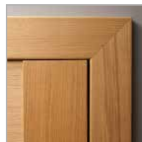
ościeżnica DIN DUO, opaski łączone pod kątem 45°
